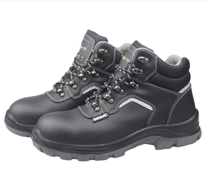
**Bocanci S3 L FO SR din piele naturală netedă de bovină, cu elemente reflectorizante, hidrofobizată cu bombeu non-metalic, talpă din poliuretan cu dublă densitate, antistatică, antiderapantă, rezistentă la abraziune și hidrocarburi.**
